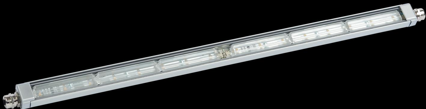
Barra a led dal ridotto consumo – soli 19W – per effetti wall grazing e wall washing. Corpo in estrusione d'alluminio anodizzato argento, vetro temprato resistente agli urti. Dotata di staffa in acciaio inox per fissaggio a parete o soffitto, oppure disponibile con forature 4MA nella parte posteriore del corpo. Grande risparmio energetico rispetto alle sorgenti di illuminazione tradizionale, ridotta manutenzione, piena luminosità immediata all'accensione, nessun fenomeno di ageing.
